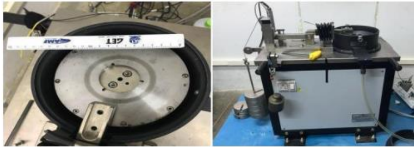
Figura 3. Sistema de Monitorização–Tribômetro com configuração pino sobre disco
