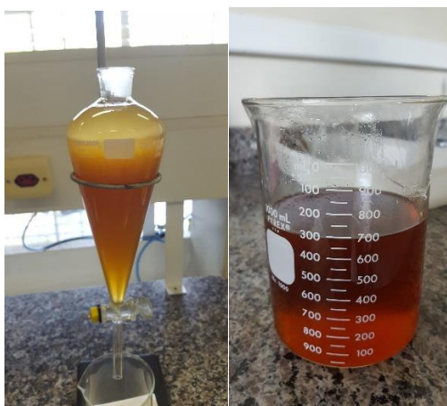
Figure 7 - Separação da glicerina bruta e do biodiesel
