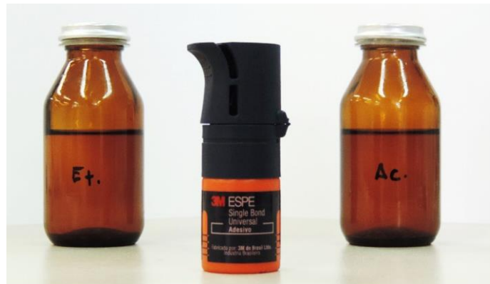
Figura 4 – Soluções extrativas e adesivo usados para a formulação dos adesivos experimentais
