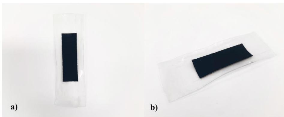
Figura 9: aspectos visuais dos eletrodos verdes produzidos em posições distintas. Na imagem, mostra-se o substrato polimérico 3,5% CNC, unido à tinta T10. a) posição frontal e b) posição diagonal.
