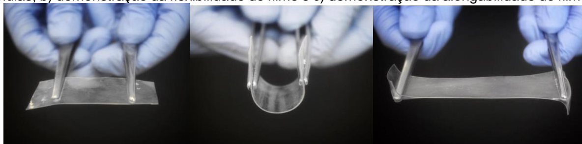
Figura 7: características visuais dos filmes dos nanocompósitos 2,5% CNC. a) filme submetido a tensões nulas; b) demonstração da flexibilidade do filme e c) demonstração da alongabilidade do filme.
