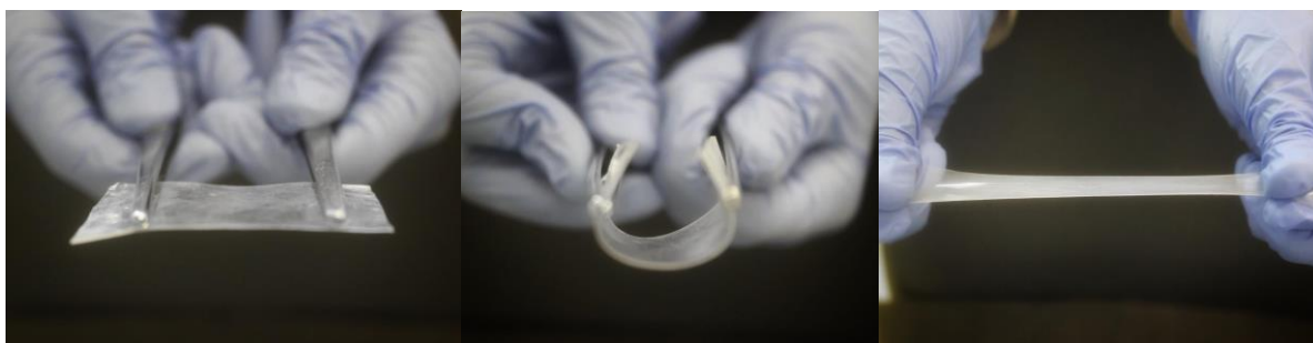
Figura 6: características visuais dos filmes de látex produzidos. a) filme submetido a tensões nulas; b) demonstração da flexibilidade do filme e c) demonstração da alongabilidade do filme.
