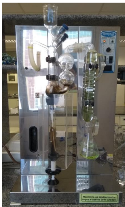
Figura 10. Destilador de Kjeldahl ou de nitrogênio utilizado na etapa de obtenção de amônia da análise de proteínas.
