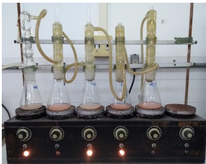
Figura 12. Sistema utilizado na análise de fibra bruta composto por placa de aquecimento, erlenmeyers e condensadores associados.
