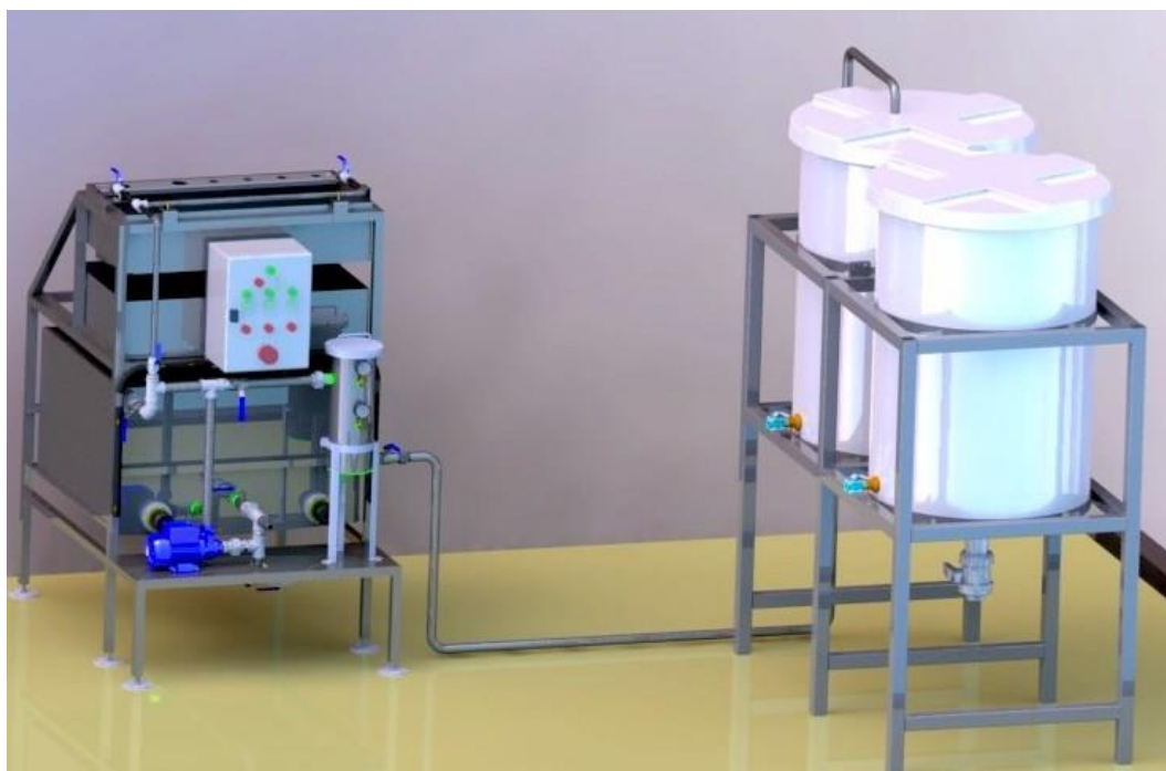
Figura 6 – Mesa filtradora e tanques de armazenamento.
