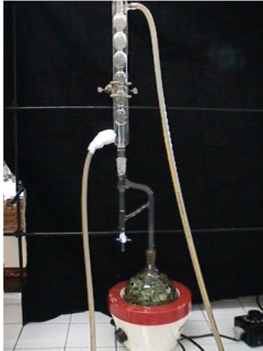
Figura 3: Extração de óleo essencial pelo método da hidrodestilação
