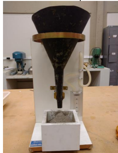
Figura 3.2 - Equipamento utilizado para ensaio da massa unitária de materiais em pó.
