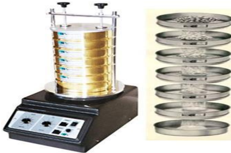
Figura 5 - Aparelho de peneiramento com jogo de peneiras
