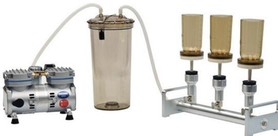
Figura 6. Equipamento para realização da técnica da membrana filtrante. Fonte: Imagens/Google
