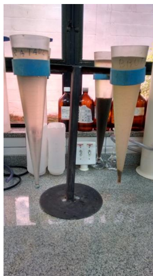
Figura 11- Cone de imhoff com amostras de efluentes bruto, tratado e tanque de aeração
